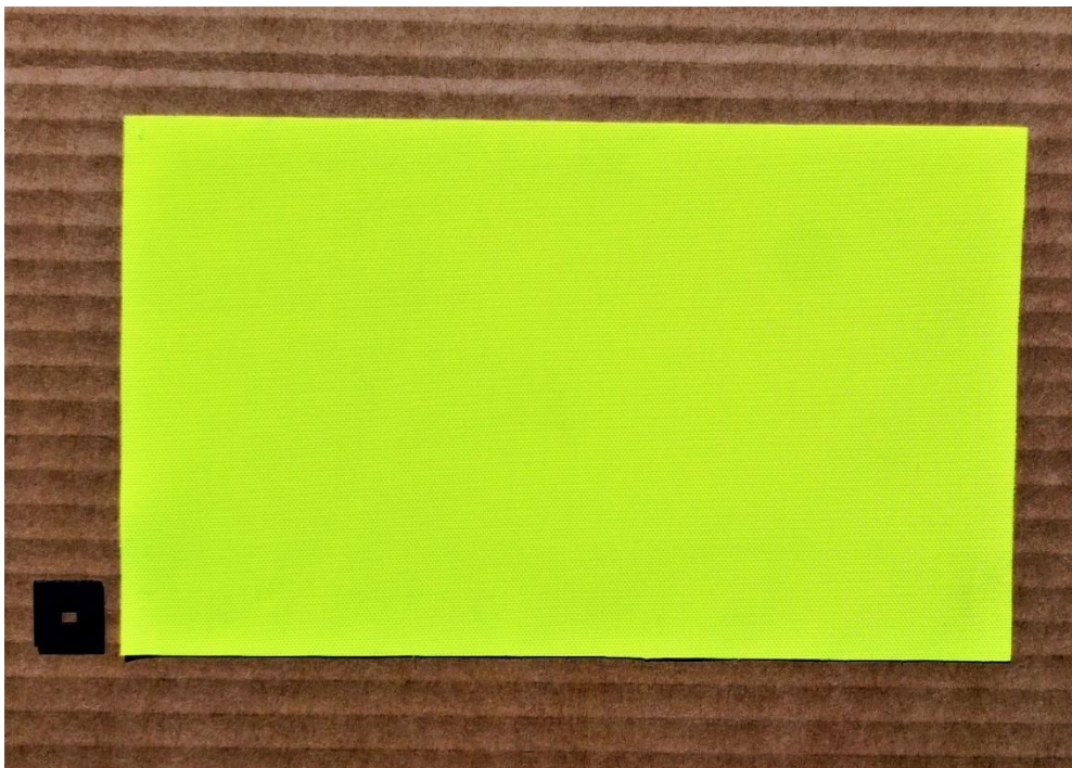
7. ábra A maradék anyagokból szabjunk ki egy 12x20 cm-es (bélésanyag) és egy 4 mmx4 mm-es (táska anyaga) részt. Érdemes ehhez is lézervágót használni, hogy a textil széle ne induljon foszlásnak, illetve a kis négyzet esetében, hogy elég precíz legyen a szenzor méretének megfelelően (4 mmx4 mm; belső négyzet 5 mmx5 mm, amit minden esetben a szenzor méretei határoznak meg).
