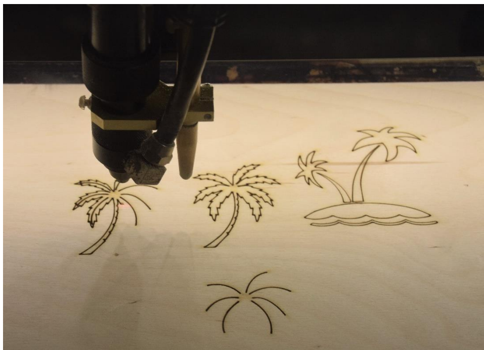
1. ábra A lézervágó feje a vektorizált útvonal mentén haladva égeti el a fát.
