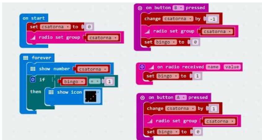
1. ábra Csatorna kommunikációt jelző program (makecode.microbit.org 2019.03.18)
