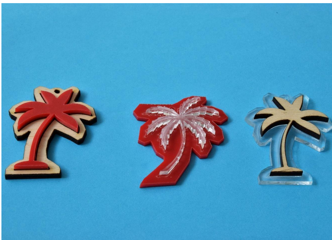
5. ábra Vágás, gravírozás. Illesztés merőlegesen, különböző anyagok felhasználásával (fa, plexi)
