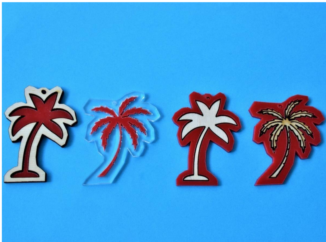
4. ábra Vágás, gravírozás – különböző anyagok egymáshoz illesztése intarziászerűen
