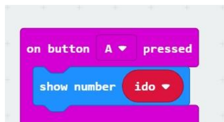
7. ábra Ezekkel a parancsokkal lehet kiírni újból a LED mátrixra a mért időt. Az „ido” nevű változónak meg kell felelnie a microbit-timer002.hex kódban lévő változónak. (makecode.microbit.org 2019.03.18)
