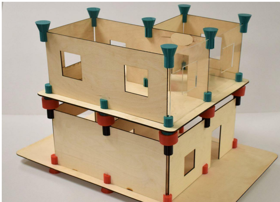
6. ábra Emelet a földszinhez illesztés után a pozicionáló gyűrűkkel
