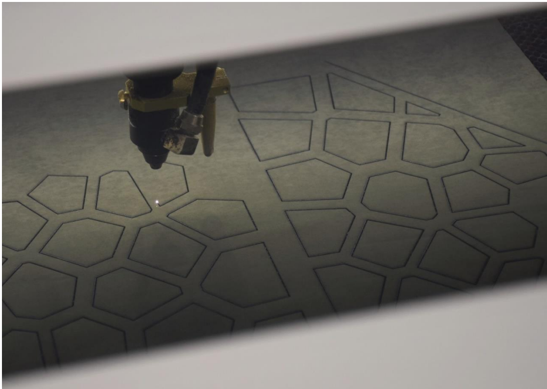
5. ábra: A felső réteg kivágása lézervágó segítségével
