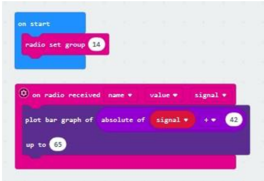
2. ábra Példa arra, hogyan jelezzük ki a micro:bit 2.4 Ghz-s Bluetooth 14-s csatornán érkező adatcsomagok jelerősségét (makecode.microbit.org 2019.03.18)
