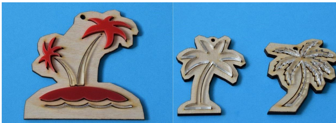
7. ábra Vágás, gravírozás. Illesztés merőlegesen, különböző anyagok felhasználásával (fa, plexi)
