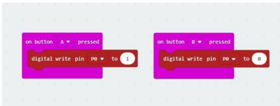
3. ábra Példaprogram arra, hogyan vezéreljünk egy külső LED-t a micro:biten található két gombbal (makecode.microbit.org 2019.03.18)
