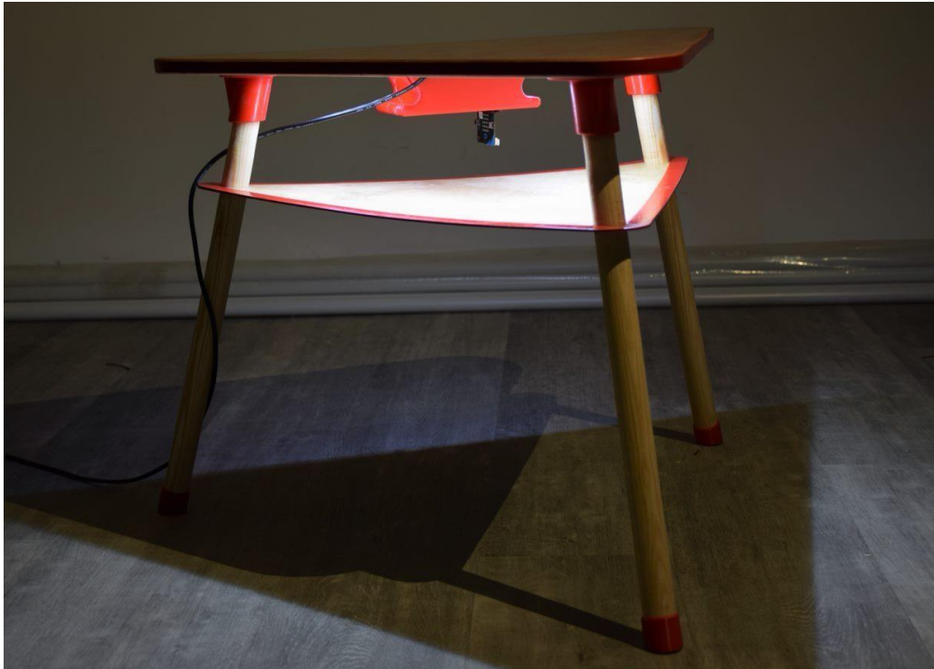
3. ábra Sötétedést érzékelő okosasztal tápegységről üzemeltetve
